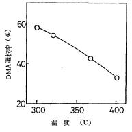
図7 反応温度と選択率(修飾モルデナイト触媒 NH<sub>a</sub>/MeOH=1 wt/1 wt, 20 atm)
