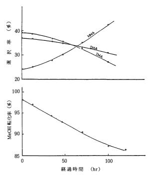
図 6 モルデナイト触媒の経時安定性 380℃, NH<sub>3</sub>/MeOH: 1/1(wt), 20 atm
